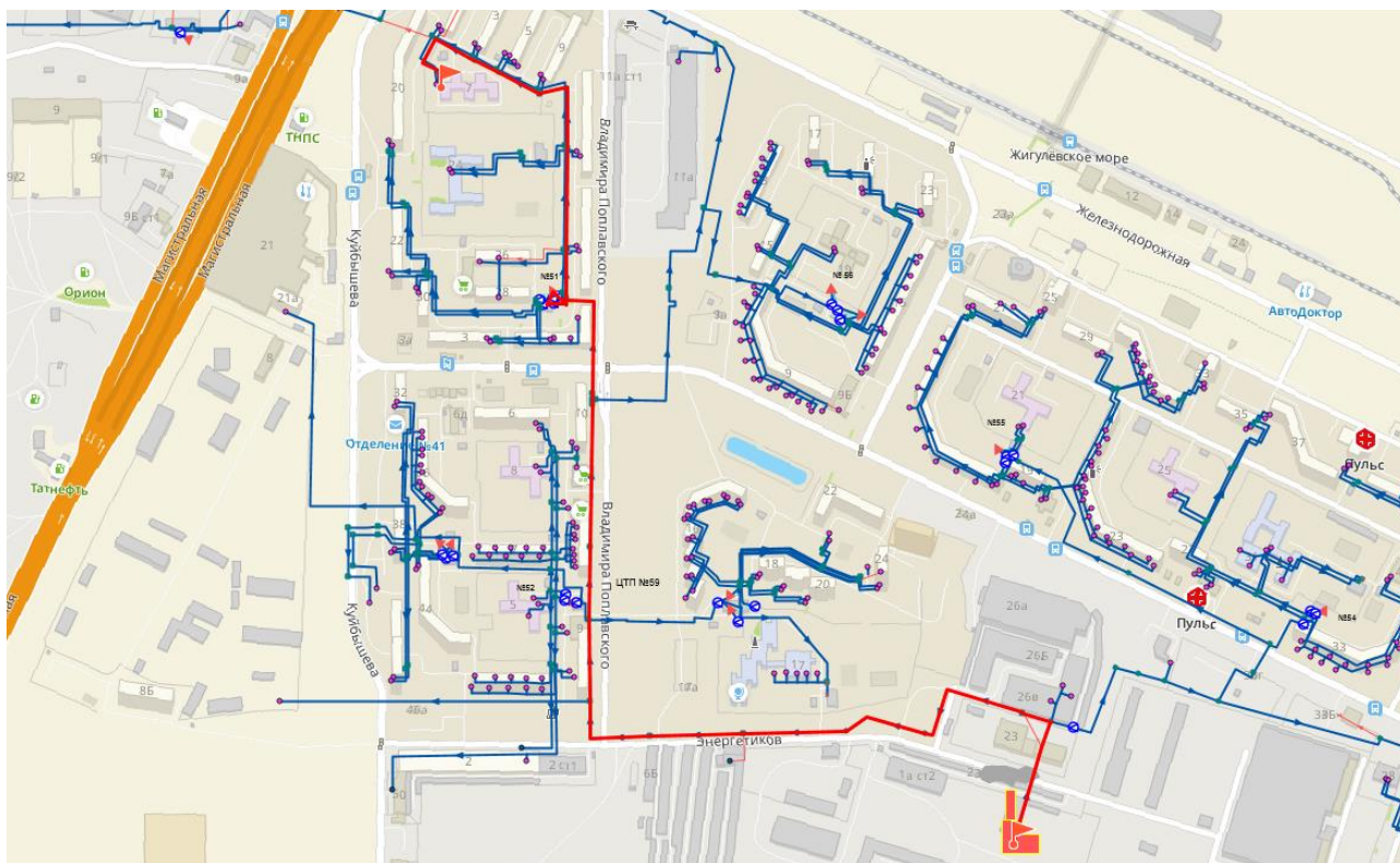
Рисунок 2.29 - Путь теплоносителя по направлению от котельной № 8 до потребителя «ул. Железнодорожная 7»
